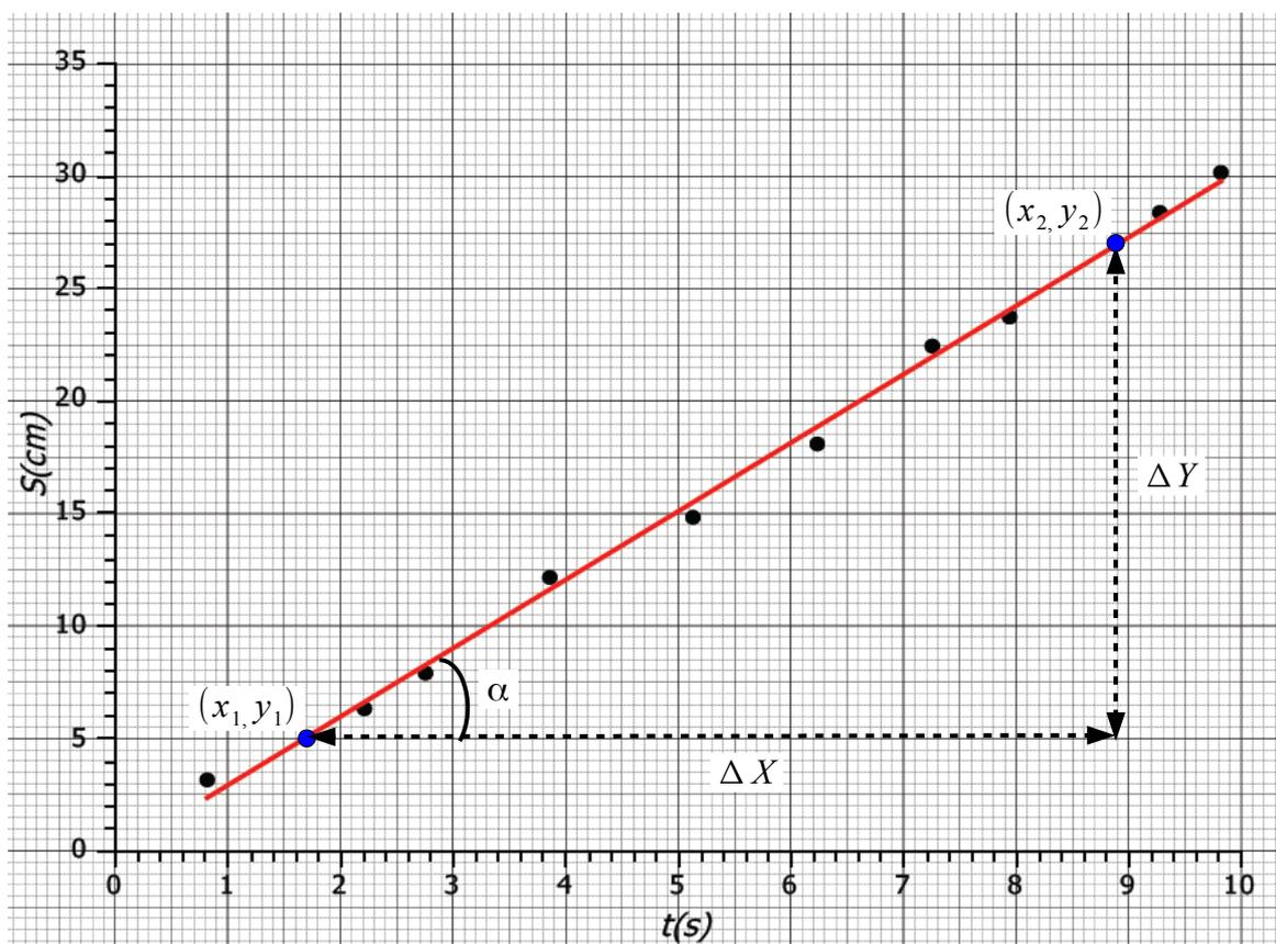
**Figura 3:** Indicação dos pontos (em azul)  $(x_1, y_1)$  e  $(x_2, y_2)$  escolhidos para o cálculo do coeficiente angular da reta média  $a$ , e dos parâmetros para o cálculo da tangente  $\tan \alpha$ .
