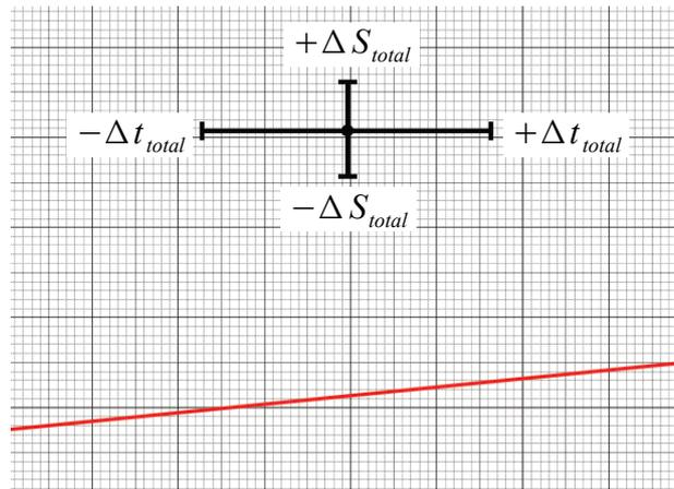
**Figura 2:** Um ponto do gráfico da **Figura 1**, com proporção de representação em escala linear que permite a visualização das barras de erro associadas ao ponto. O tamanho de cada barra é dado pelo erro total de cada grandeza.
